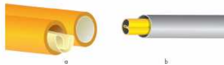
Figura 42 - Fobbed Lining - piegatura del tubo
