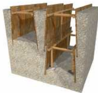
Figura 3 - Esempio di scavo ed armatura in fasi successive (marciavanti)
