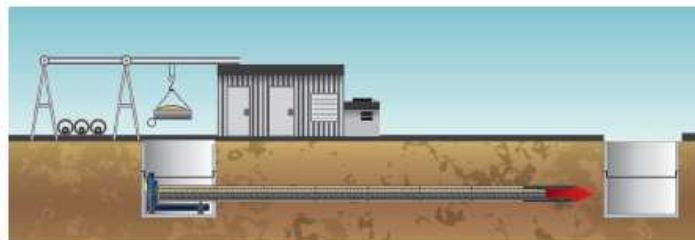
Figura 35 - Microtunneling - sistema con smario meccanico
