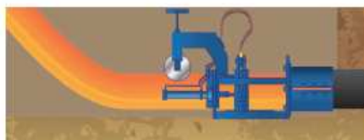
Figura 41 - Swage lining - attrezzatura per prefabbricazione
